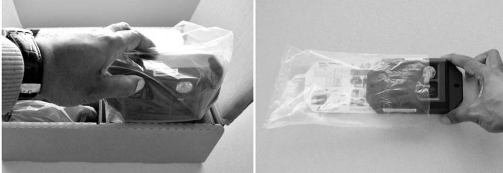
2. Retire la tapa de la batería de la parte posterior del dispositivo. Desmonte la bolsa con cierre del separador de cartón y téngala cerca. Necesitará estos tornillos para fijar la tapa de la batería a la carcasa exterior y completar el proceso de montaje del módulo.
