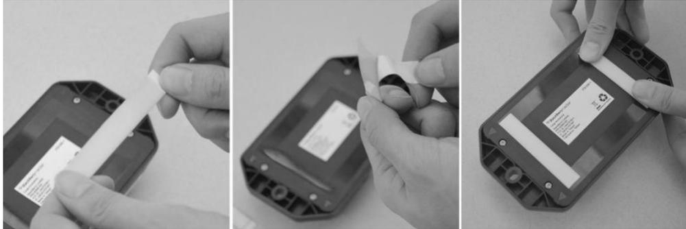
4. Retire el protector transparente. Alinee el borde inferior del módulo con la marca y coloque el módulo en la superficie de montaje preparada. Ejercer una ligera presión (15 psi) en el módulo durante 30-45 segundos para garantizar la adherencia de la cinta adhesiva a la superficie de montaje.
