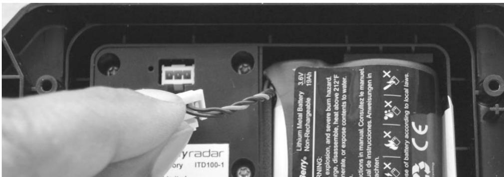
3. Para extraer la batería del compartimento de la batería, sujete la lengüeta y levante la batería para extraerla del compartimento.
