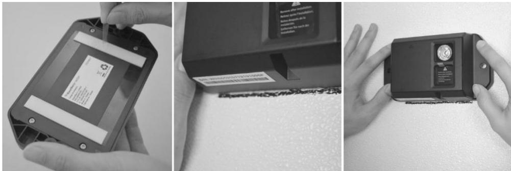
5. Retire el revestimiento del objetivo y cierre la puerta. La instalación se ha completado.
