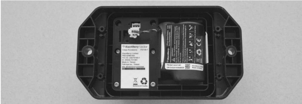
2. Conecte el cable de la batería al conector de la batería. El LED parpadeará para indicar que el módulo está activo. **NOTA:** La secuencia de parpadeo puede tardar hasta 5 segundos en comenzar. Tenga paciencia. Cuando observe que el LED parpadea, continúe con el paso siguiente.
