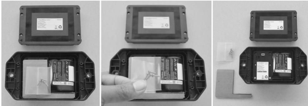
**Sugerencia:** Si le cuesta extraer la carcasa interior de la exterior, puede introducir una herramienta, como un destornillador, cerca de las flechas en relieve de la tapa y levantarla para separarla de la carcasa.
