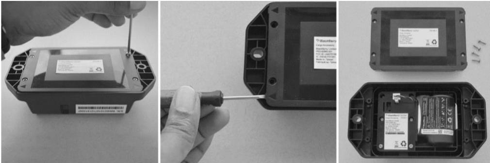
2. Asegúrese de que el cable de la batería está desconectado del conector de la batería. Levante la batería y coloque el conector debajo de ella. Vuelva a colocar la batería en el compartimento.
