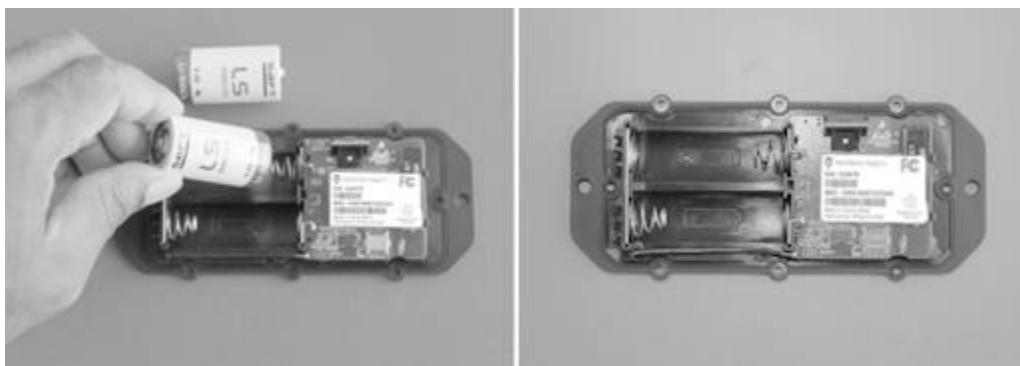
3. Repérez le boîtier supérieur et placez-le sur le boîtier inférieur. **IMPORTANT** : Vérifiez que la fenêtre du capteur brillant est orientée vers le haut de l'appareil. Cette fenêtre de capteur doit être alignée avec le composant capteur situé au sommet de la carte de circuit.
