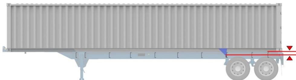
Pour obtenir ce dégagement minimal, essayez de positionner le module aussi bas que possible sur la traverse du châssis, sans dépasser le bas du module au-delà du bord inférieur de la traverse. L'extension du bord inférieur du module au-delà du bord inférieur de la traverse peut exposer le module à des dommages potentiels.
