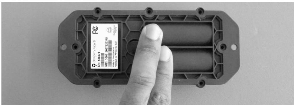
5. Insérez les 8 vis et serrez-les uniformément. Couple de serrage des vis recommandé : 4,4 à 5 po-lb (0,5 à 0,6 N-m).
