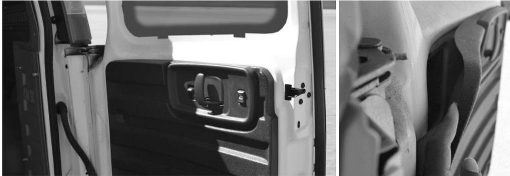
**Sugerencia:** En algunos vehículos, cuando planifique la ubicación de montaje frente a un pestillo, puede que desee verificar la idoneidad de la zona para el montaje comprobando detrás del panel interior de la puerta.
