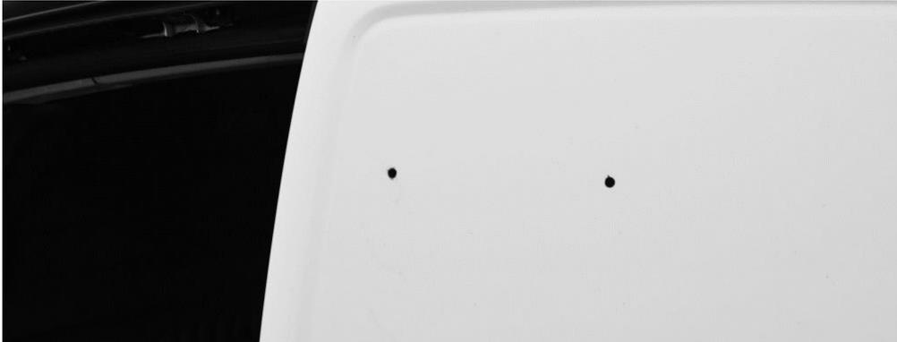
2. Hágase con un conjunto de tapones de nailon o goma, con el diámetro adecuado, para tapar los orificios. Estos tapones se pueden adquirir en tiendas de ferretería o suministros para automoción. Introduzca los tapones en los orificios. Si lo desea, puede aplicar sellador para exteriores 100 % de silicona en la parte posterior de los tapones para aumentar la protección y sellar los huecos frente a la entrada de agua.
