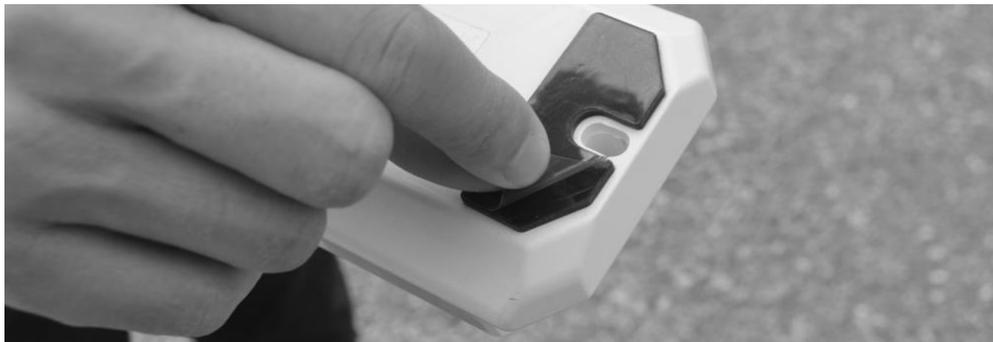
6. Coloque el módulo en la puerta, alineando los orificios del módulo con los que ha taladrado en la puerta. Para colocar el adhesivo, presione el módulo firmemente contra la superficie de instalación durante 30-45 segundos.
