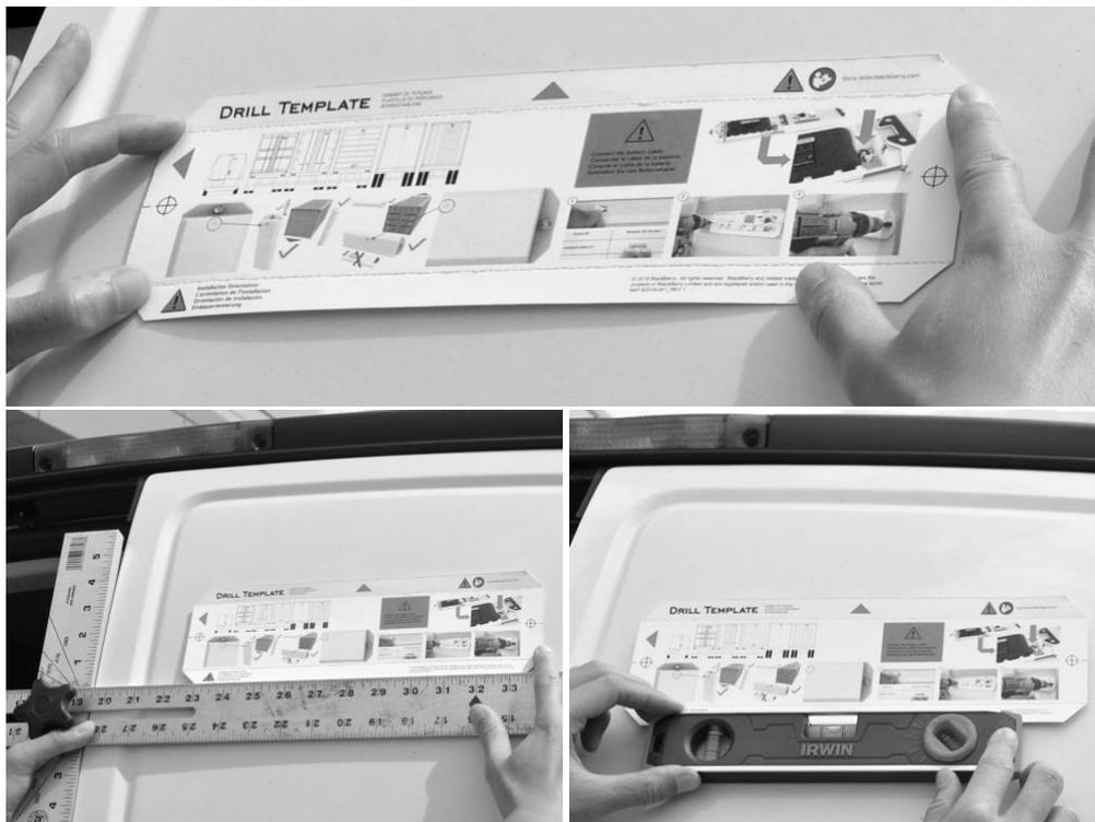
3. Con una broca, taladre un orificio a través de cada retículo de la plantilla. Así creará los dos orificios que utilizará para montar el módulo.
