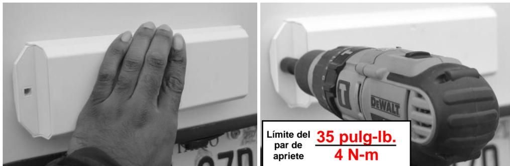
No apriete demasiado el tornillo de fijación. Si los aprieta en exceso podrían comprimir demasiado la almohadilla de montaje y dañarla. No apriete el tornillo de fijación más de 35 pulg-lb. (4 N-m).
