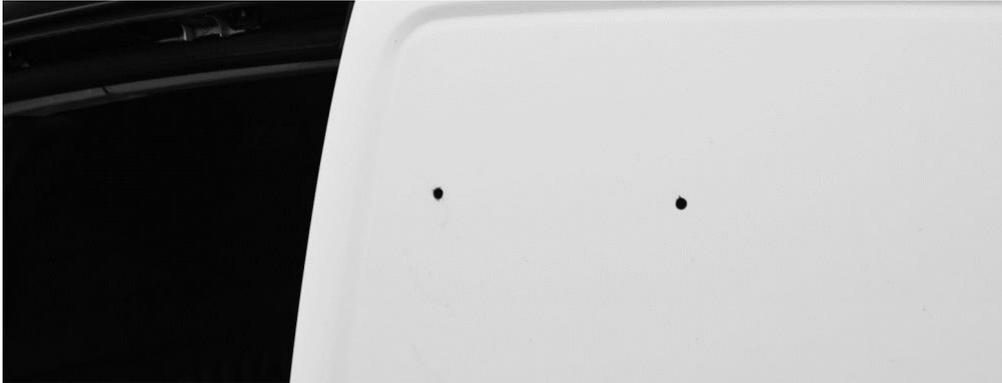
2. Procurez-vous un ensemble de bouchons en caoutchouc ou en nylon d'un diamètre adapté pour boucher les trous. Ces bouchons sont disponibles dans des magasins de bricolage ou d'approvisionnement automobile. Insérez les bouchons dans les trous. Si vous le souhaitez, vous pouvez ajouter du mastic 100 % silicone adapté à l'extérieur, à l'arrière du bouchon, pour une protection supplémentaire et pour éviter les infiltrations d'eau.
