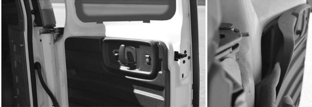
**Conseil :** sur certains véhicules, lorsque l'emplacement de montage prévu est situé devant un loquet, il est conseillé de vérifier l'adéquation de la zone à l'installation en observant l'arrière du panneau de porte intérieur.
