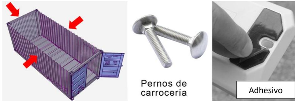
Los pernos de carrocería son como pernos estándar, pero con una cabeza diferente. La cabeza de un perno de carrocería tiene forma abovedada, con una protuberancia cuadrada que sobresale por el lado plano. La protuberancia cuadrada de la base se introduce en las ranuras cuadradas del módulo. La ranura cuadrada sujeta el perno en su sitio cuando se aprieta una tuerca en este, mientras que en un perno estándar se requiere una herramienta para sujetar el perno mientras se aprieta la tuerca.
