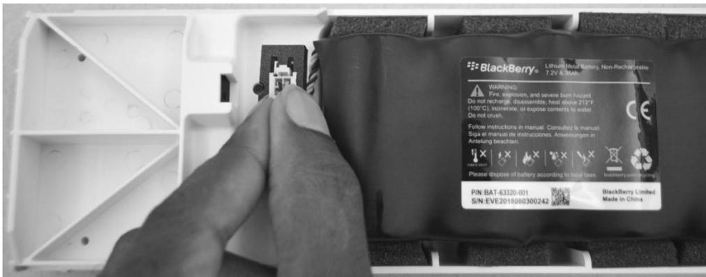
3. Para extraer la batería del compartimento de la batería, sujete la lengüeta y levante la batería para extraerla del compartimento.
