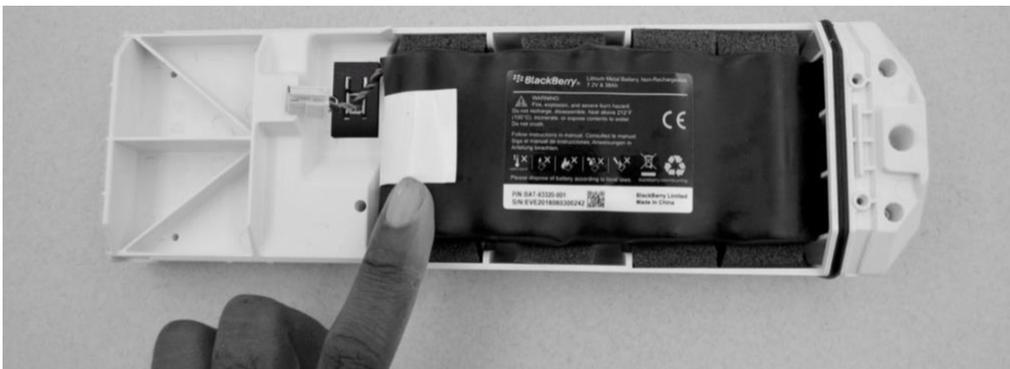
2. Conecte el cable de la batería al conector de la batería. El LED parpadeará para indicar que el módulo está activo. NOTA: La secuencia de parpadeo puede tardar entre 20 y 30 segundos en comenzar. Tenga paciencia. Cuando observe que el LED parpadea, continúe con el paso siguiente.
