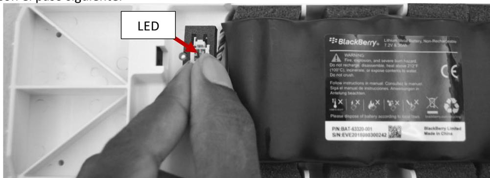
**IMPORTANTE:** Al conectar el cable de la batería al conector de la batería, no retire la lengüeta de retención de la espuma de retención del conector de la batería ni coloque la
