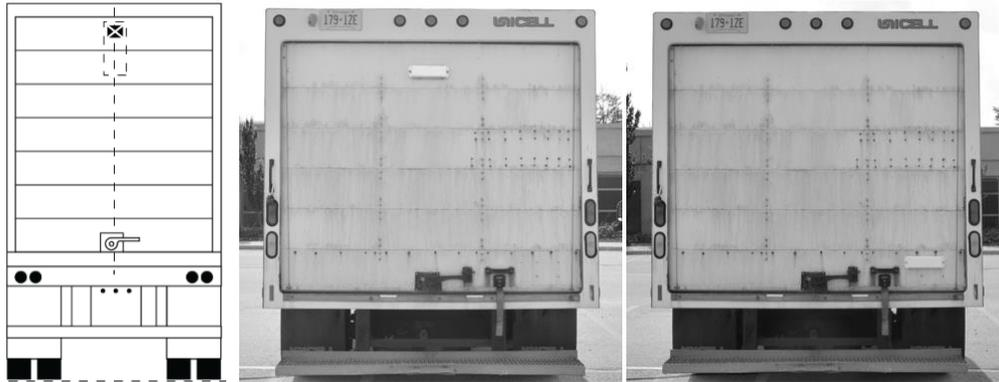
**IMPORTANTE:** Si va a emparejar el módulo BlackBerry Radar-H2 con un sensor de carga BlackBerry Radar, asegúrese de no instalar el módulo BlackBerry Radar-H2 a una altura que impida la instalación del sensor de carga a las alturas de colocación necesarias que se muestran en la ilustración siguiente.
