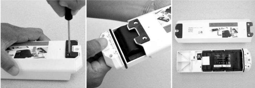
2. Desconecte el cable de la batería del conector de la batería.
