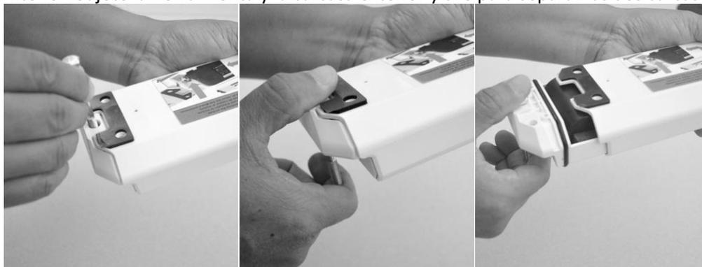
3. Retire el conector de la batería del hueco del conector y conecte el cable de la batería al conector de la batería. El LED parpadeará para indicar que el módulo está activo. NOTA: La secuencia de parpadeo puede tardar entre 20 y 30 segundos en comenzar. Tenga paciencia. Cuando observe que el LED parpadea, continúe con el siguiente paso.
