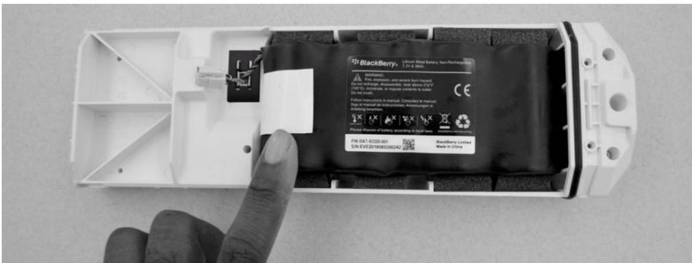
2. Conecte el cable de la batería al conector de la batería. El LED parpadeará para indicar que el módulo está activo. NOTA: La secuencia de parpadeo puede tardar entre 20 y 30 segundos en comenzar. Tenga paciencia. Cuando observe que el LED parpadea, continúe con el paso siguiente.
