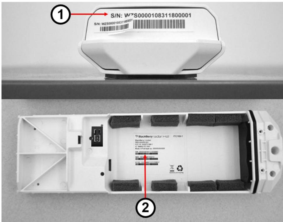
2. Cuando esté listo para instalar el módulo en el activo, retire la etiqueta colocada parcialmente de la superficie delantera de la carcasa exterior y colóquela en la hoja de trabajo, junto al identificador del activo con el que se va a emparejar el módulo.
