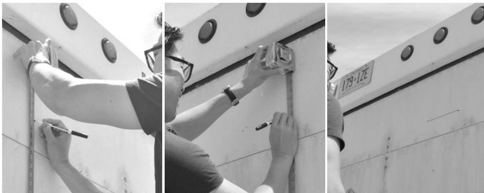
4. Retire la línea adhesiva de la parte posterior de la plantilla y coloque esta en la ubicación de instalación deseada. El adhesivo de la parte posterior de la plantilla garantiza que se sostendrá sobre la superficie de la puerta, por lo que se podrán perforar los orificios de forma precisa.
