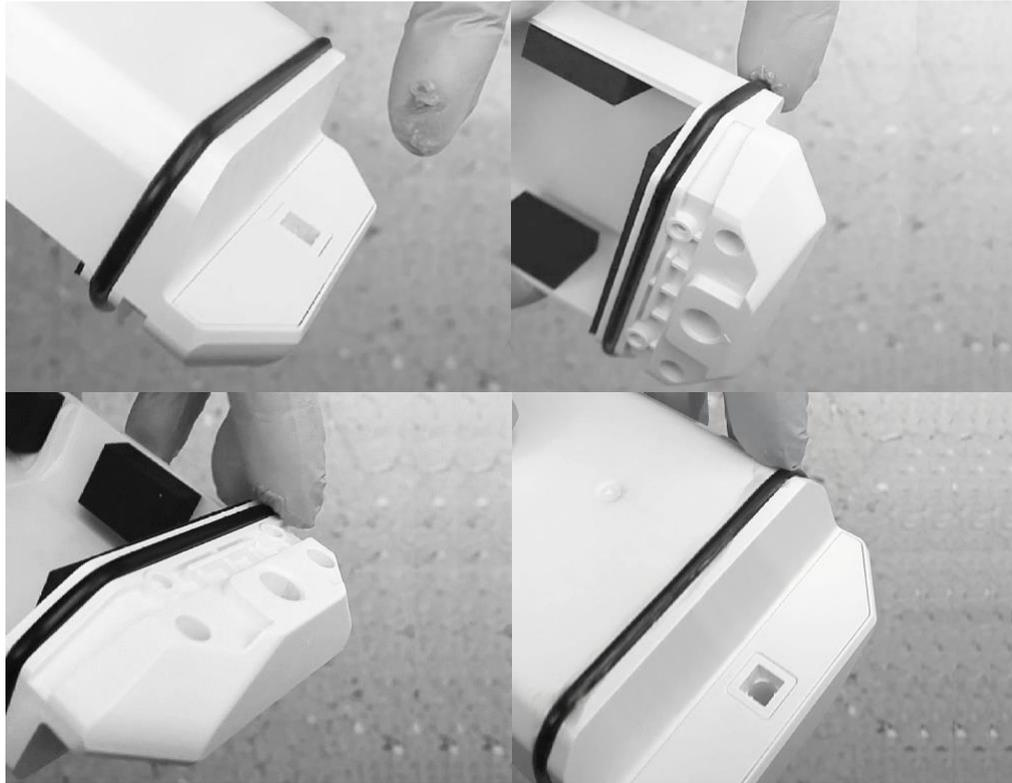
4. Introduzca por completo la carcasa interior en la exterior. Utilice los dos tornillos incluidos con el dispositivo para fijar la carcasa. **IMPORTANTE:** El par de apriete del tornillo debe ser de 3 a 3.5 pulg-lb. (de 0.35 a 0.4 N-m).
