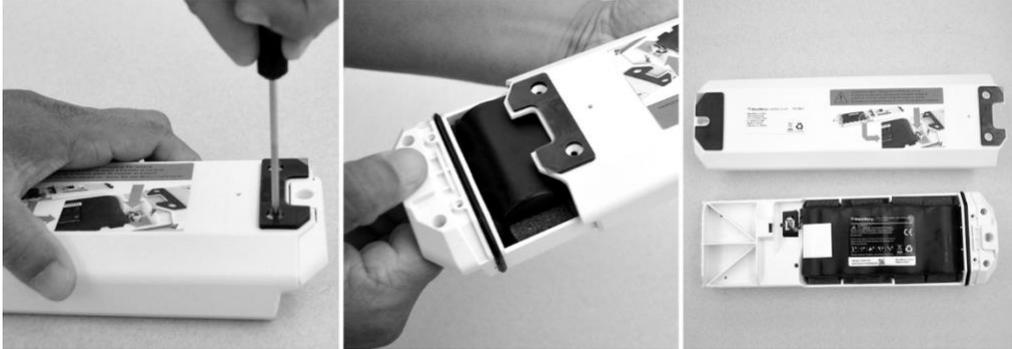
2. Asegúrese de que el cable de la batería está desconectado del conector de la batería. Coloque el cable de la batería dentro del receptáculo del conector de la batería.
