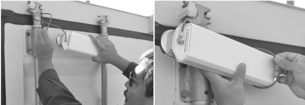
3. Sur le côté gauche du module, retirez l'écrou de la vis. Retirez l'attache et la rondelle du boulon, puis retirez l'aimant du module.
