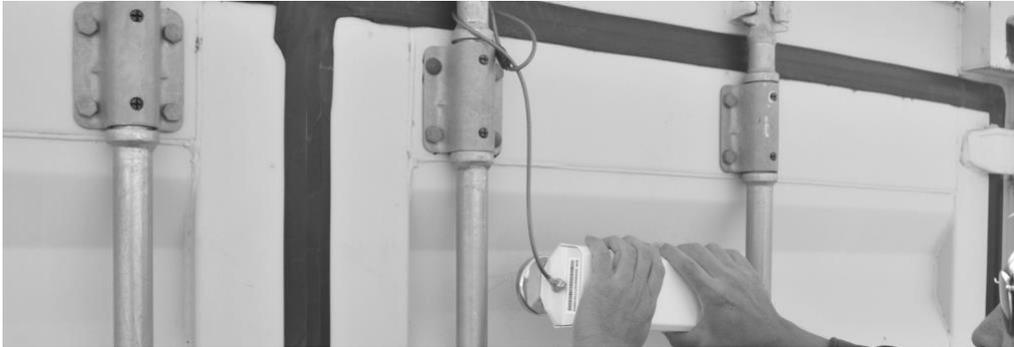
2. Desserrez la grande boucle de l'attache, puis faites passer le module dans la boucle.
