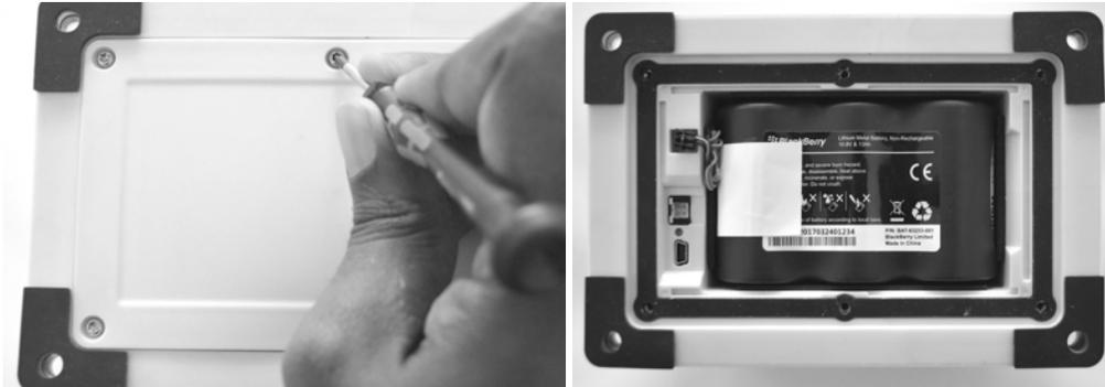
2. Assurez-vous que le câble de la batterie est débranché du connecteur. Placez le câble de la batterie dans le creux du connecteur.
