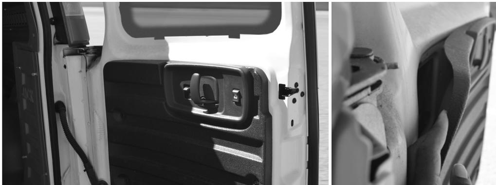
**Conseil :** sur certains véhicules, lorsque le lieu d'installation prévu est situé devant un loquet, il est conseillé de vérifier l'adéquation de la zone à l'installation en observant l'arrière du panneau de porte intérieur.
