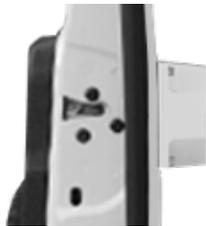
**4 boulons et écrous à sertir**
