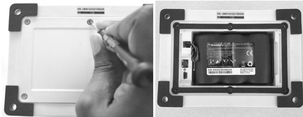
3. Retire el conector de la batería del hueco del conector y conecte el cable de la batería al conector de la batería. El LED parpadeará para indicar que el módulo está activo.
