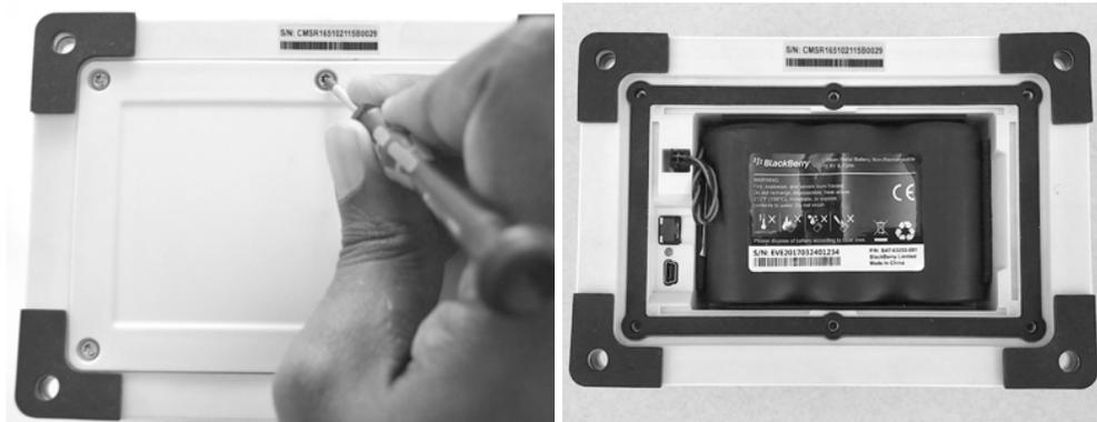
3. Retirez le connecteur de la batterie du renforcement du connecteur et branchez le câble de la batterie au connecteur. Le voyant clignote pour indiquer que le module est actif.
