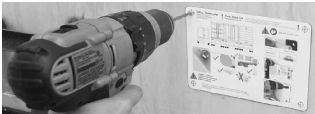
**Conseil :** si votre actif est isolé (à savoir réfrigérant ou chauffant) et si vous souhaitez éviter les pertes thermiques dues au perçage complet à travers la porte, nous vous recommandons de limiter la profondeur du perçage. Cette approche nécessite l'utilisation d'écrous à sertir pour terminer l'installation.
