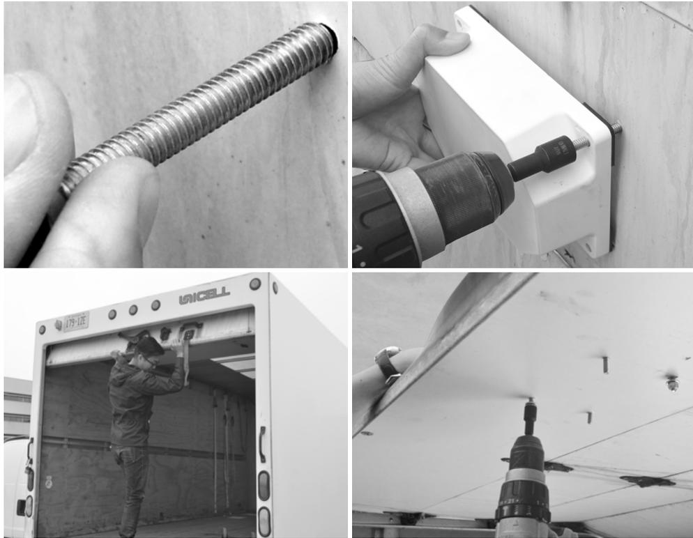
**Installation en bas d'une porte : écrous, boulons et rondelles uniquement**
