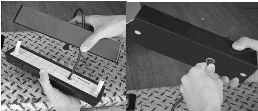
3. Retirez les vis du module externe. Gardez-les à proximité car vous en aurez besoin pour assembler les deux modules au support de châssis.
