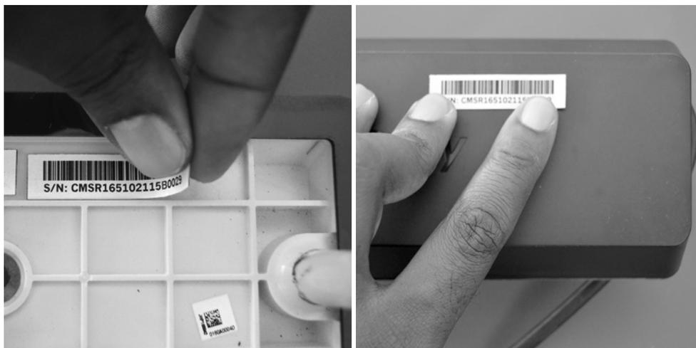
3. Lorsque vous êtes prêt à installer l'assemblage à l'actif, assurez-vous d'avoir la fiche d'installation sur vous. Retirez l'étiquette partiellement apposée qui se trouve sur la surface extérieure du module externe et placez-la sur la fiche, à côté de l'identifiant d'actif auquel le terminal sera associé.
