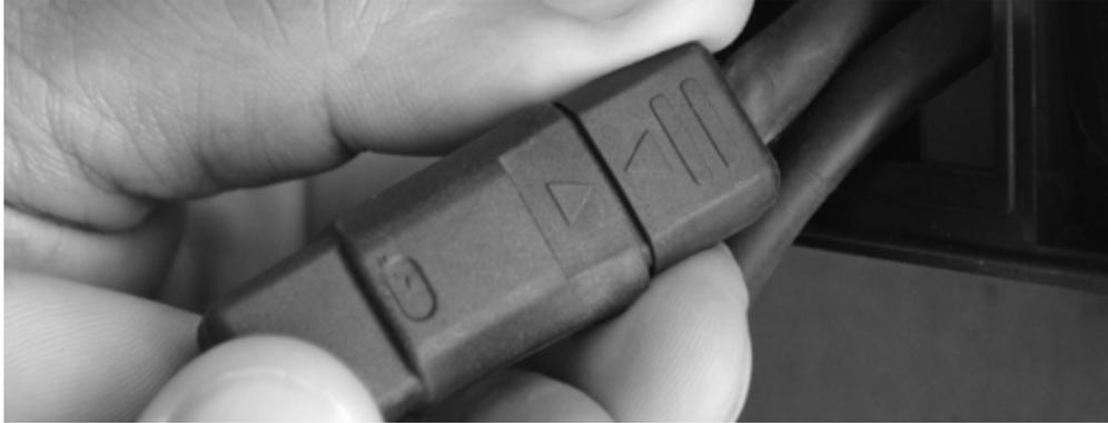
12. Une fois les câbles raccordés, le voyant clignote pendant dix secondes environ. Le clignotement du voyant indique que l'appareil est allumé. **Remarque** : le voyant peut ne commencer à clignoter que 20-30 secondes après le raccordement des câbles.
