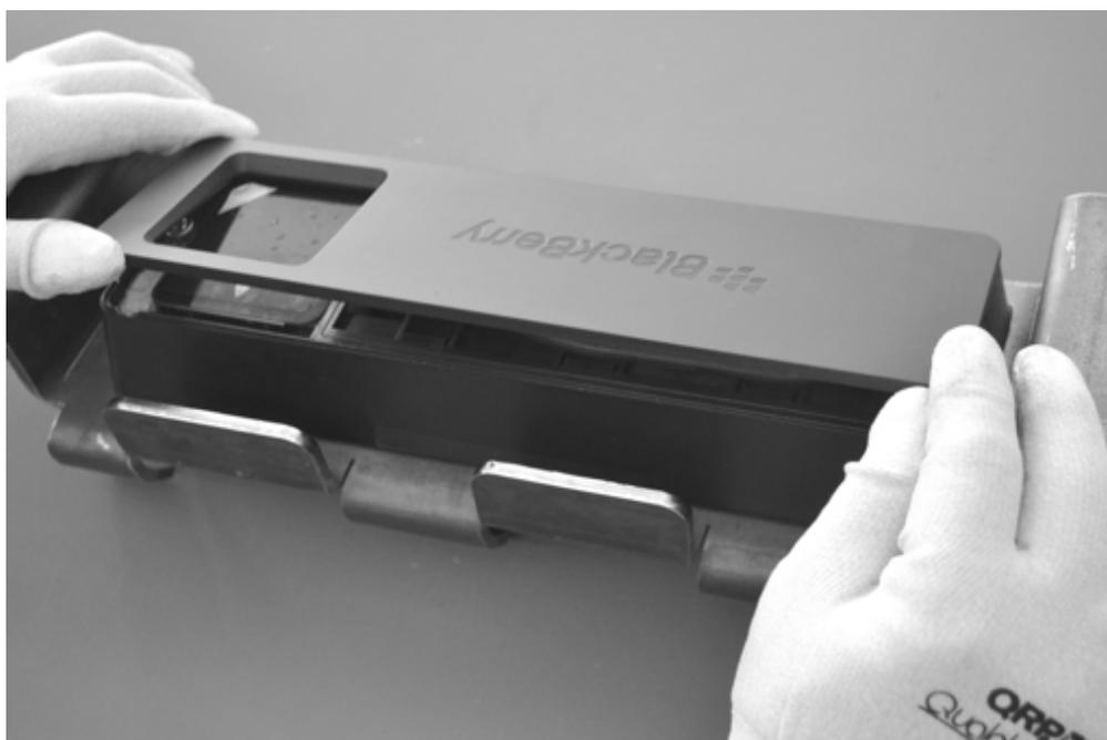
Les images suivantes illustrent la différence entre un couvercle correctement installé, avec tous les fermoirs enclenchés, et un couvercle mal installé.
