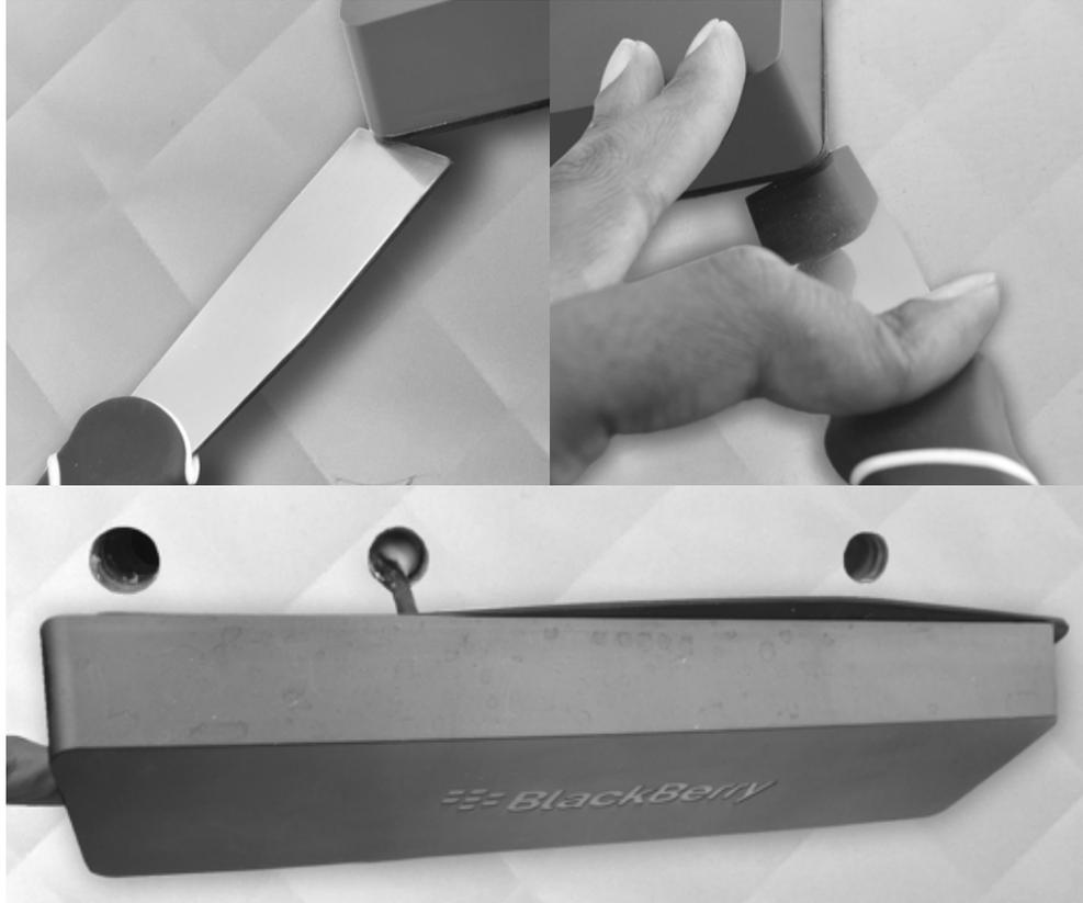
C. Desde el interior del tráiler, utilice el destornillador para empujar el sellador y forzar su paso a través del orificio, para extraerlo por la parte posterior del tráiler. Cuando haya salido la suficiente cantidad del tapón de sellador por el orificio, extráigalo entero desde el exterior del tráiler y pase el cable por el orificio para finalizar la extracción del módulo del tráiler.
