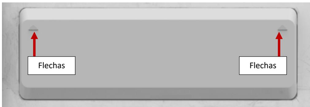
11. Presione de forma uniforme el módulo externo durante unos 30-45 segundos para asegurarse de que se adhiera a la pared. El adhesivo mantendrá el módulo externo en su lugar mientras se realiza la instalación.
