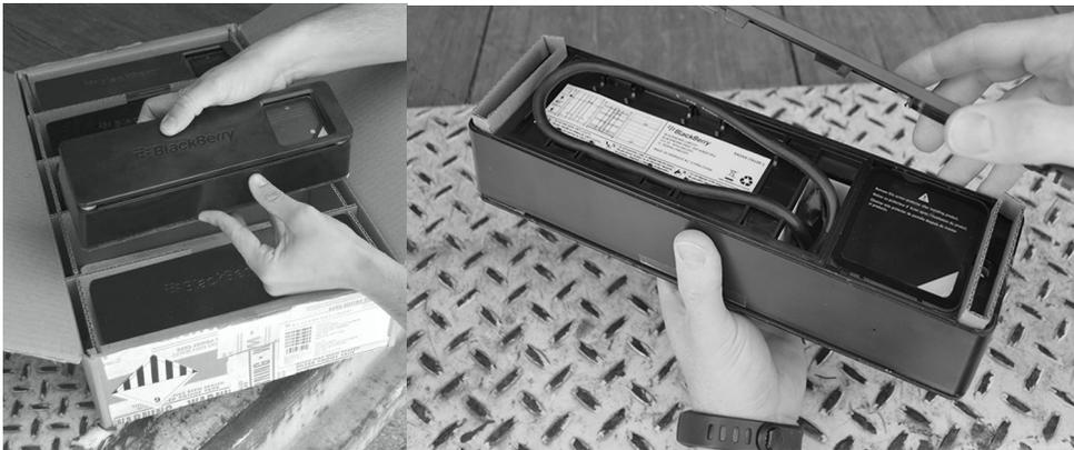
2. Separe el módulo interno del externo. Para separar completamente los dos módulos, deberá pasar el conector del cable a través del orificio de la parte posterior del módulo interno.
