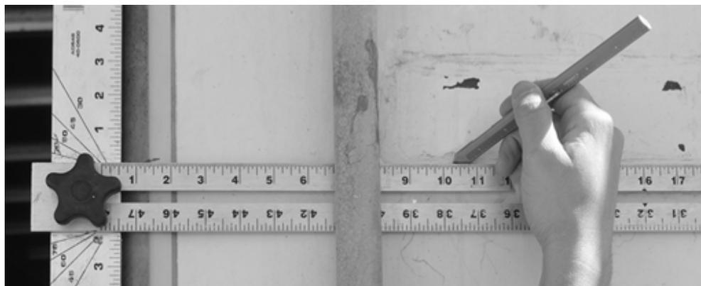
**Técnica 2:** si lo prefiere, puede utilizar cinta para transportar la marca desde el borde de la puerta a la superficie exterior del contenedor. Esto puede ser útil si no tiene suficiente espacio libre para colocar una regla T entre la puerta y la barra de la puerta.
