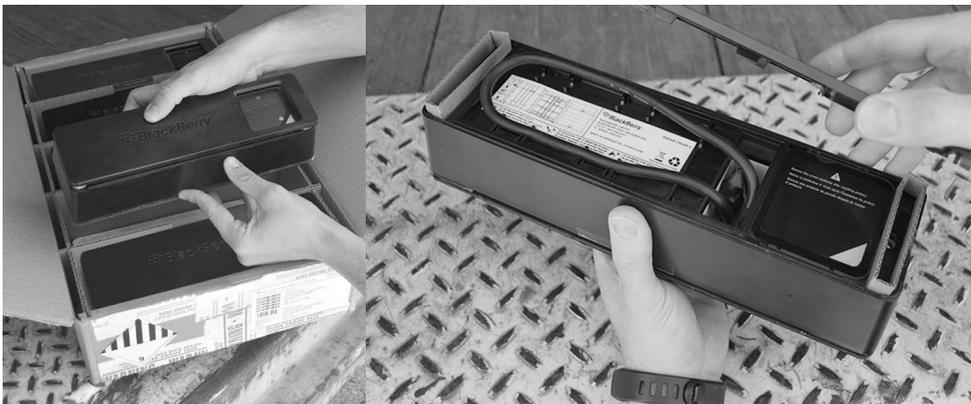
2. Séparez le module interne du module externe. Pour séparer complètement les deux modules, vous devez guider le connecteur de câble dans le trou à l'arrière du module interne.
