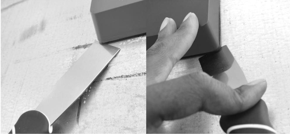
**Conseil :** si vous retirez le module en suivant la méthode 2, une lame large et plate faite d'un matériau résistant (par exemple, un couteau à mastiquer en métal) vous aidera à le détacher.
