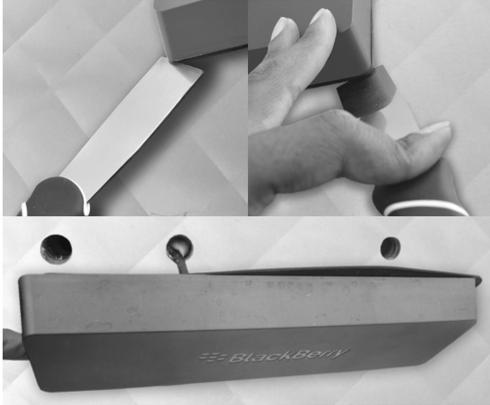
C. Depuis l'intérieur de la remorque, poussez le produit d'étanchéité à travers le trou à l'aide du tournevis jusqu'à le faire sortir à l'extérieur de la remorque. Lorsqu'une quantité suffisante de produit d'étanchéité dépasse du trou, saisissez-le depuis l'extérieur de la remorque. Tirez-le pour l'extraire tout en passant le câble à l'extérieur pour retirer complètement le module de la remorque.
