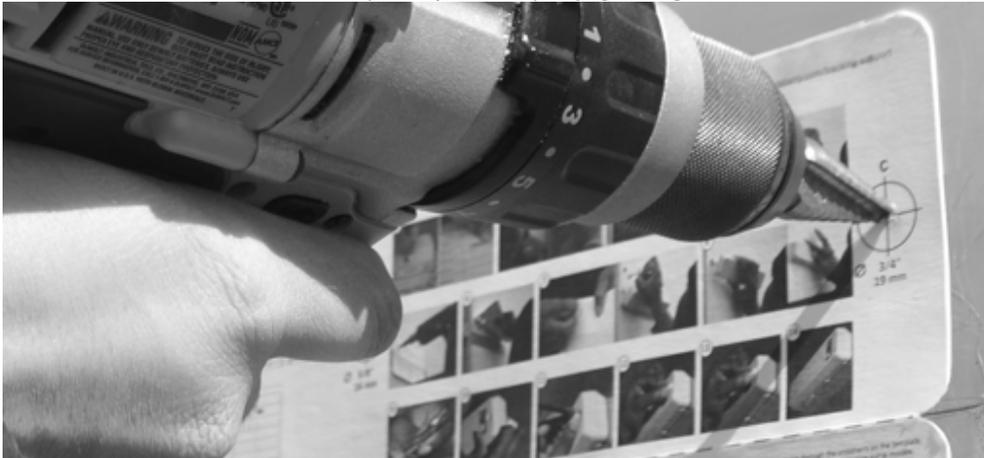
**Remarque :** utilisez un foret étagé pour réduire le temps de perçage et obtenir des trous sans imperfections. Les forets étagés augmentent aussi la vitesse de perçage de l'acier très résistant utilisé dans la fabrication des conteneurs intermodaux. Pour réduire un peu plus le temps de perçage et prolonger la durée de vie de votre foret, enduisez-le d'huile de coupe avant utilisation.
