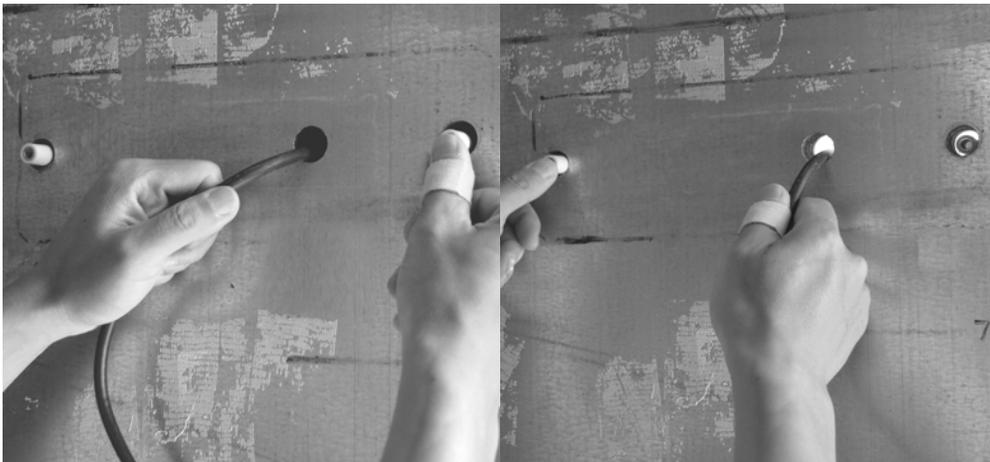
**Conseil** : si vous retirez le module en suivant la méthode 1, placez un chiffon ou un morceau de bois entre votre main et les bossages à vis pour pousser le module plus confortablement.
