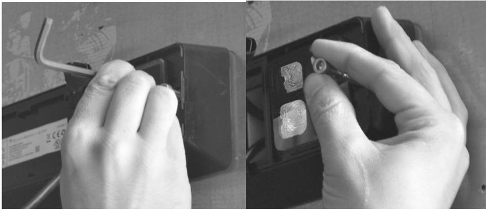
5. Retirez le module interne de la porte. Guidez le module interne le long du câble et le connecteur dans le trou du module interne.
