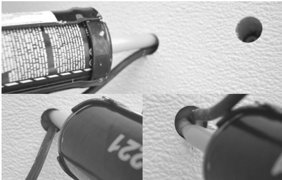
13. Si le produit d'étanchéité déborde sur la paroi intérieure de la porte, retirez immédiatement l'excès. Pour que l'installation soit réussie, le terminal doit être complètement collé à la paroi de la porte. Si nécessaire, retirez l'excès de produit d'étanchéité avec un couteau à mastiquer et une serviette imbibée d'alcool.
