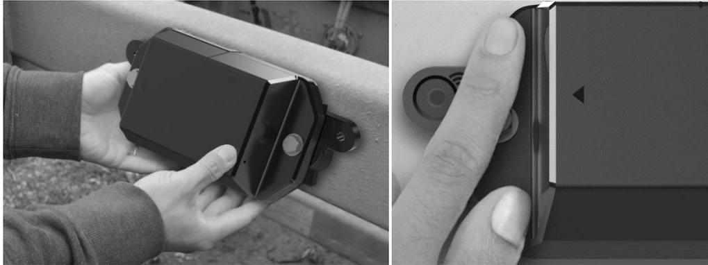
Inserte la fijación de su elección en los orificios y utilice las herramientas adecuadas para asegurar el módulo al activo. No apriete la fijación más allá de 35 pulg-lb. (4 N-m).
