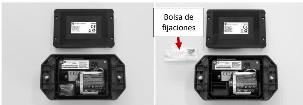
**Sugerencia:** Si le resulta difícil quitar la carcasa interior de la carcasa exterior, puede insertar una herramienta, como un destornillador, cerca de las flechas en relieve ubicadas en la tapa y levantarla para separar la tapa de la carcasa.
