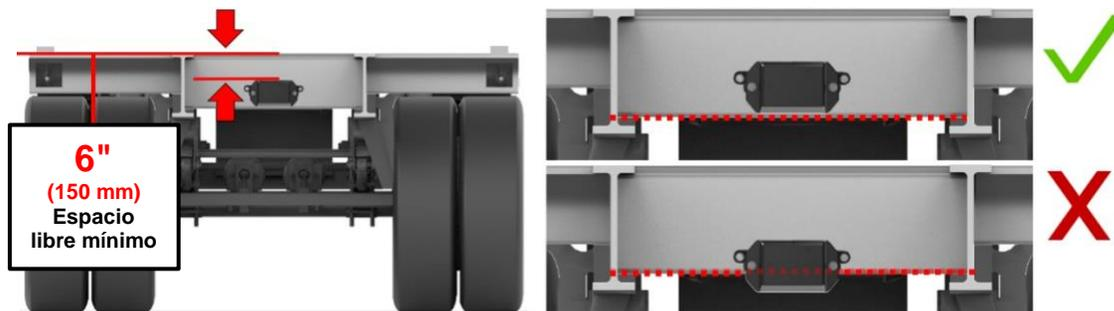
**IMPORTANTE:** Para detectar con precisión la presencia de un contenedor en el chasis, es importante comprobar que haya un espacio libre mínimo de 6" (15 cm) entre la superficie superior del módulo y la superficie superior del riel del bastidor principal.
