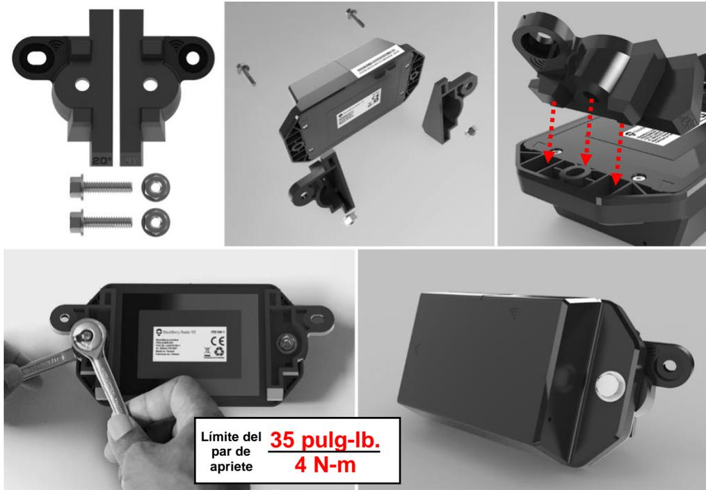
**IMPORTANTE:** Compruebe que el ícono de señal de cada soporte de inclinación en 20° del Radar R2 esté en la misma orientación que el ícono de señal del módulo Radar R2.
