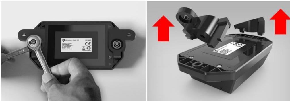
2. Quite los cuatro tornillos de la parte posterior del producto y separe la carcasa interior de la carcasa exterior para acceder a la batería. Conserve los tornillos, ya que todos serán necesarios para volver a fijar la carcasa interior a la carcasa exterior.
