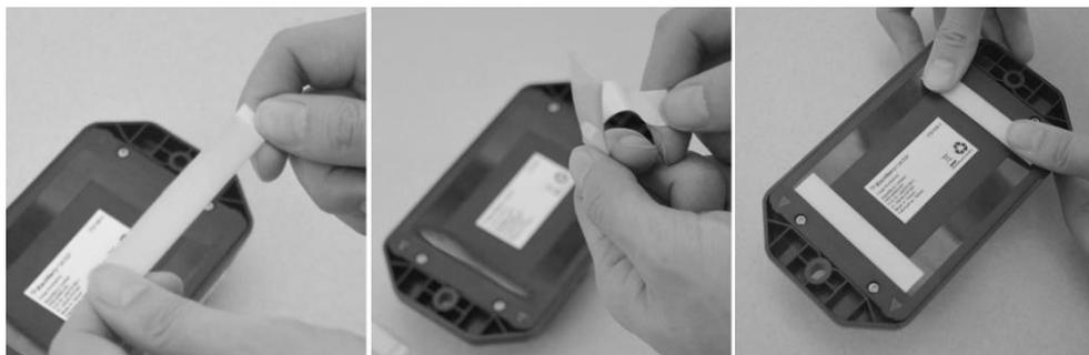
8. Quite el recubrimiento transparente. Alinee la línea central en el borde delantero del módulo con la línea central en el bastidor de puerta y coloque el módulo sobre la superficie de montaje preparada. Aplique una presión firme (15 psi) al módulo durante 30 a 45 segundos para asegurarse de que las uniones adhesivas se unan a la superficie de montaje.
