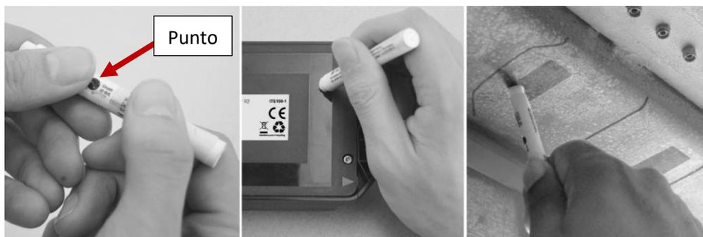
7. Retire el recubrimiento blanco extendido de la parte posterior de la cinta. Aplique a la tapa de la batería. Utilice una presión firme (mínimo de 15 psi) para garantizar que el adhesivo se pegue a la puerta de la batería.
