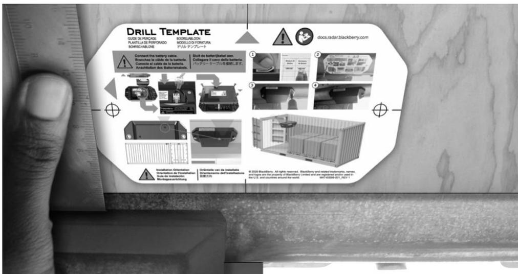
4. Con una broca, perfora un orificio a través de cada una de las cruces de la plantilla. De esta forma, creará dos orificios que utilizará para montar el módulo.
