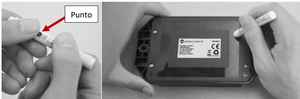
3. Retire el recubrimiento blanco extendido de la parte posterior de la cinta. Aplique a la tapa de la batería. Utilice una presión firme (mínimo de 15 psi) para garantizar que el adhesivo se pegue a la puerta de la batería.
