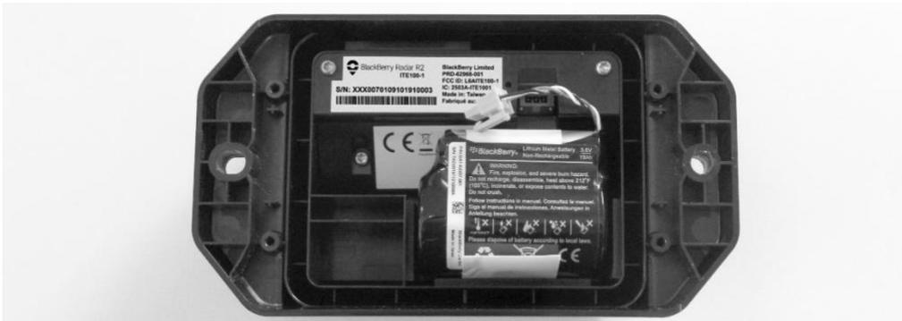
2. Conecte el cable de la batería al conector de la batería. El LED parpadeará para indicar que el módulo está activo. **NOTA:** La secuencia de parpadeo puede tardar hasta 5 segundos en iniciarse. Sea paciente. Una vez que el LED parpadee, continúe con el siguiente paso.
