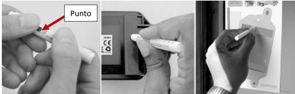
**Sugerencia:** Si ha quitado las secciones perforadas de la plantilla de instalación, aplique el imprimador dentro de las aberturas. Estas aberturas identificarán con precisión las áreas donde se aplicará el imprimador universal 3M VHB a la superficie de instalación.
