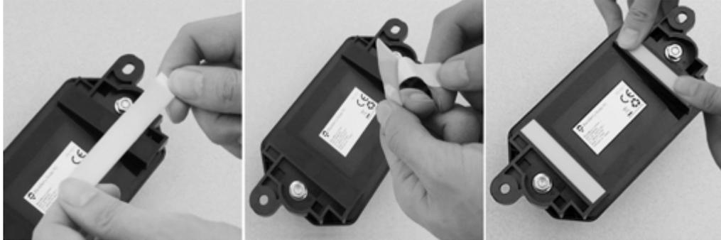
9. Quite el recubrimiento transparente. Alinee los orificios del soporte en 20° con las áreas que marcó en la pared y coloque el módulo en la superficie de montaje preparada. Aplique una presión firme (15 psi) al módulo durante 30 a 45 segundos para asegurarse de que las uniones adhesivas se unan a la superficie.
