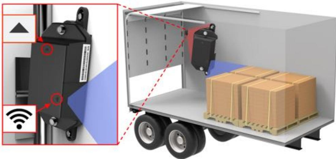
**IMPORTANTE:** Cuando instale el módulo BlackBerry Radar R2 en un activo con puertas levadizas, la parte inferior del módulo debe estar instalada a 70" (178 cm) por encima del piso. Esto es importante para la precisión de la detección de carga.
