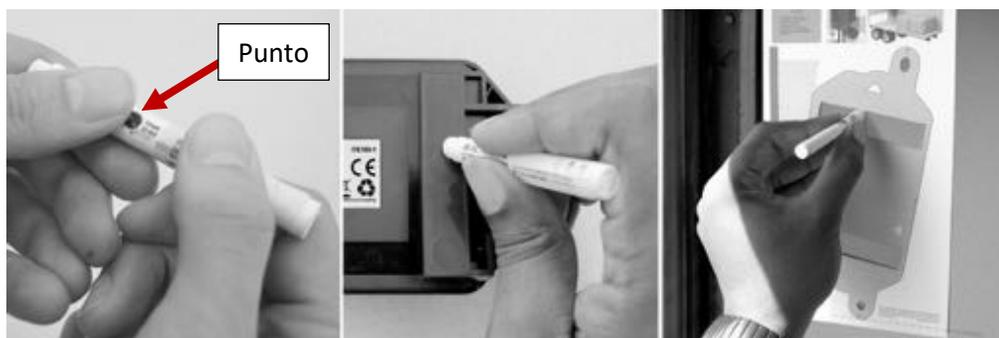
9. Quite el recubrimiento transparente. Alinee el borde delantero del módulo con la marca y coloque el módulo sobre la superficie de montaje preparada. Aplique una presión firme (15 psi) al módulo durante 30 a 45 segundos para asegurarse de que las uniones adhesivas se unan a la superficie de montaje.
