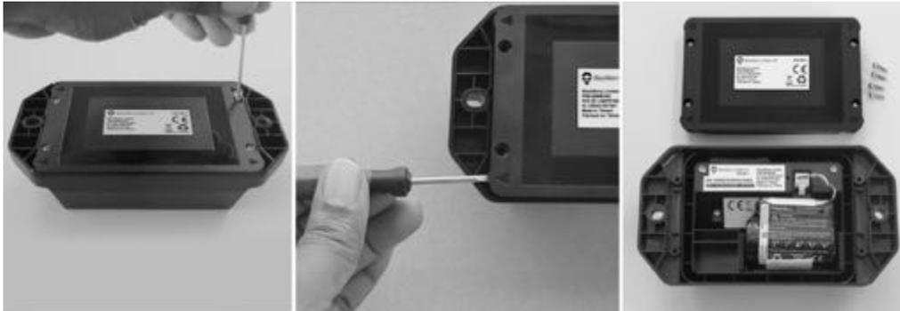
2. Compruebe que el cable de la batería esté desconectado del conector de la batería. Levante la batería y coloque el conector debajo de esta. Vuelva a colocar la batería en su contenedor.
